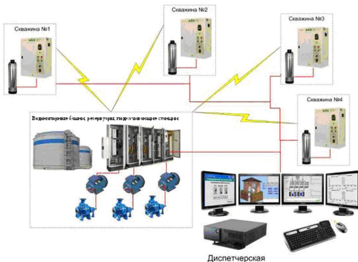
Рисунок 27 – Схема автоматизации, диспетчеризации и управления
