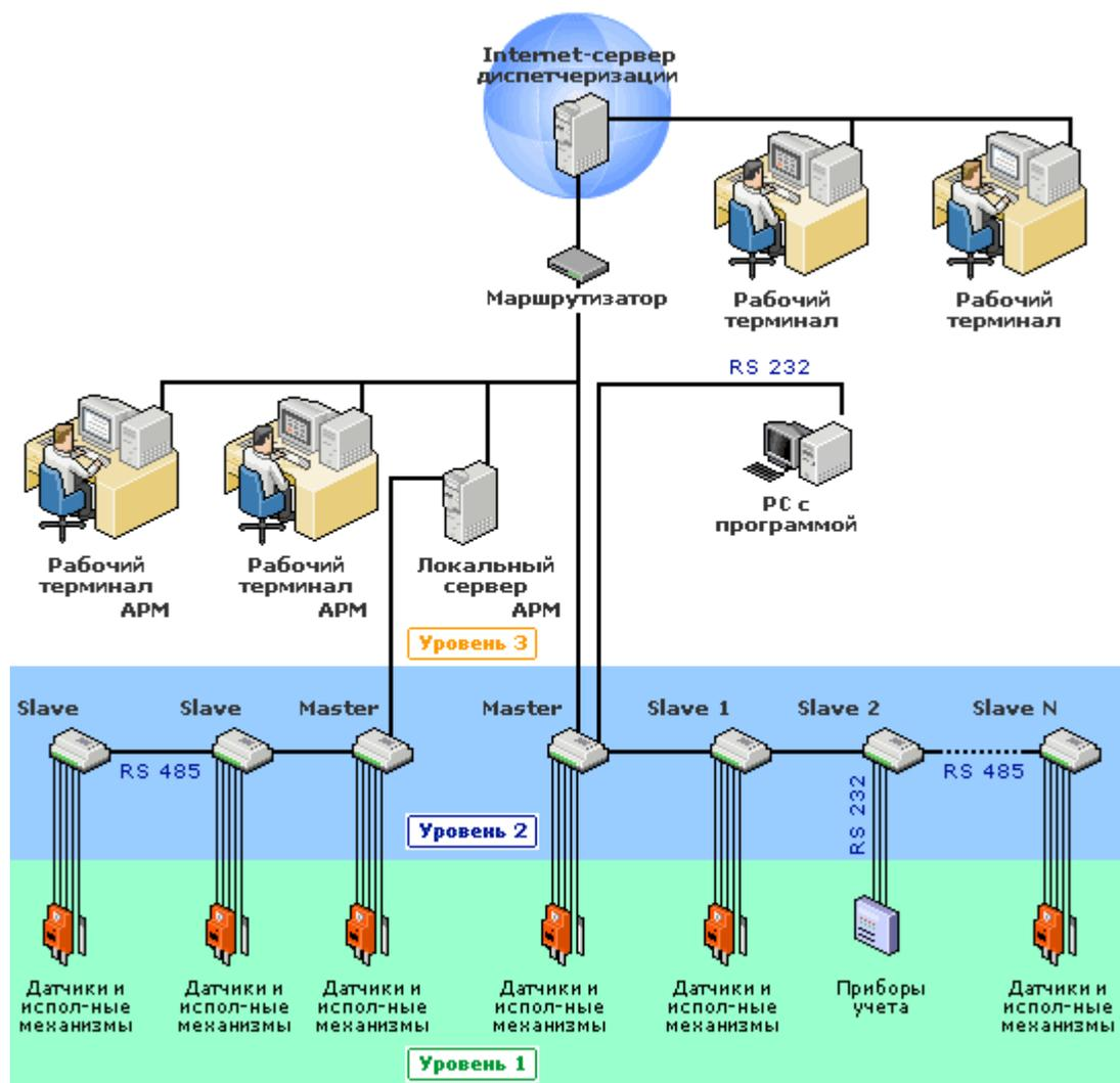
Рисунок 28 – Схема уровней системы АСУ ТП
