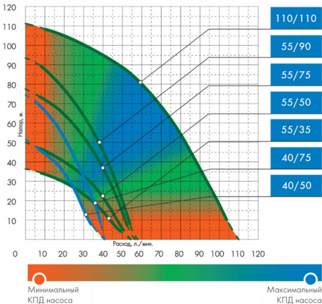
Рисунок 4 – Напорные характеристики насосных агрегатов марки Водомет Проф
