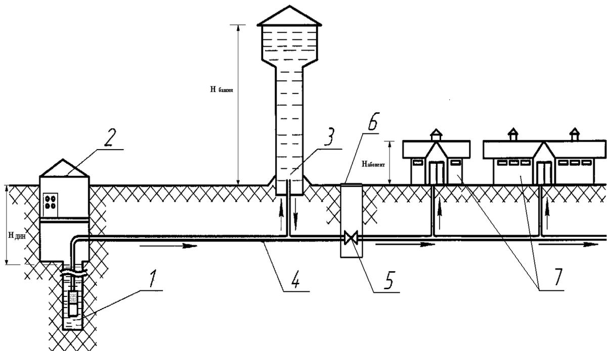
1 — артезианская скважина; 2 — павильон; 3 — водонапорная башня; 4 — водопроводная сеть; 5 — запорная арматура; 6 — водопроводный колодец; 7 — потребители (абоненты).
