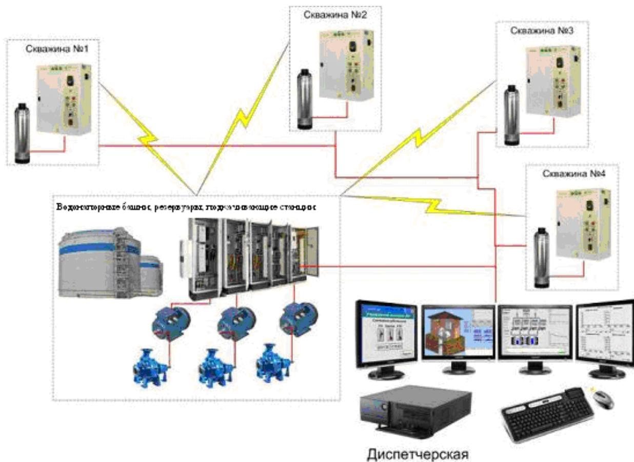
Рисунок 28 – Схема автоматизации, диспетчеризации и управления
