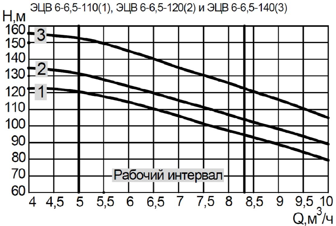
Рисунок 3 – Напорные характеристики насосных агрегатов марки ЭЦВ
