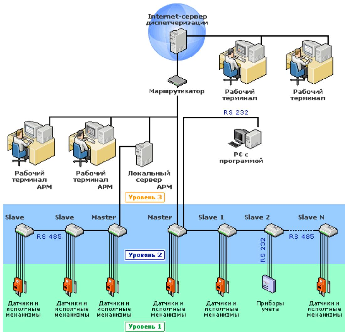
Рисунок 29 – Схема уровней системы АСУ ТП
