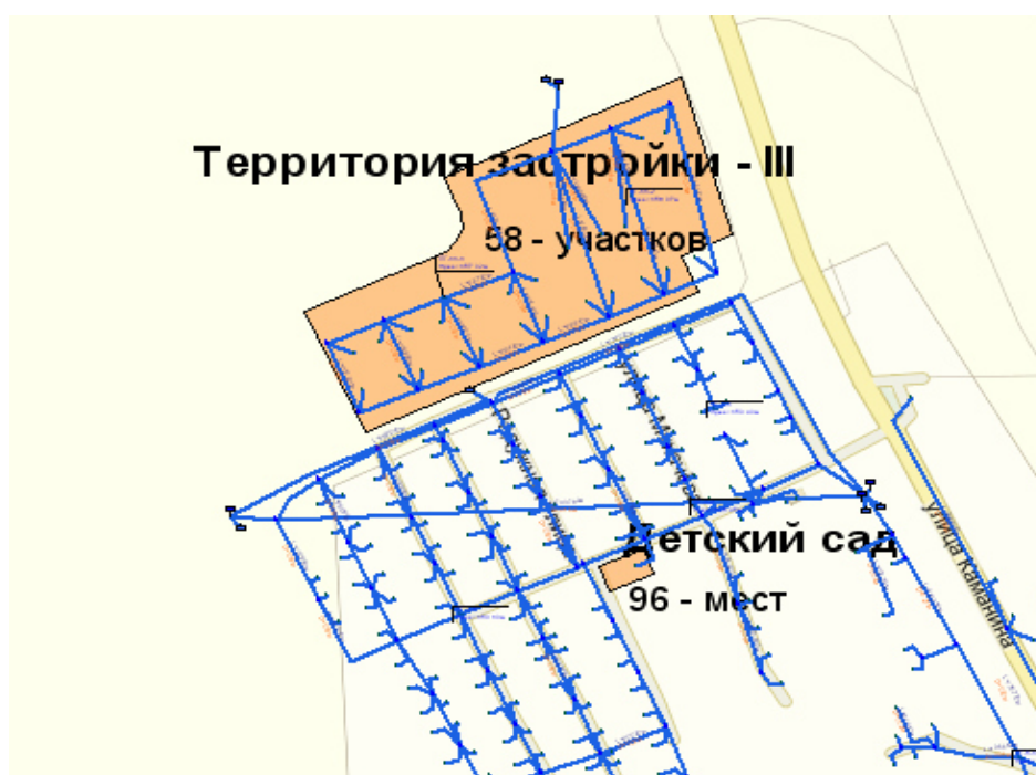
Рисунок 65 – Участки предлагаемые для строительства сети водоснабжения на территории перспективной застройки в верхней зоне водоснабжения
