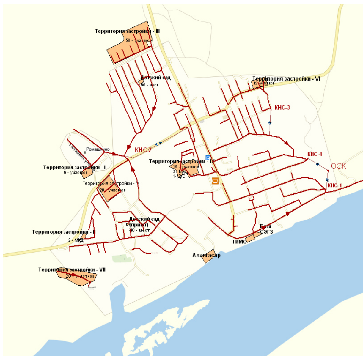
Рисунок 72 - Предлагаемая сеть централизованной системы канализации в с. Каракулино.
