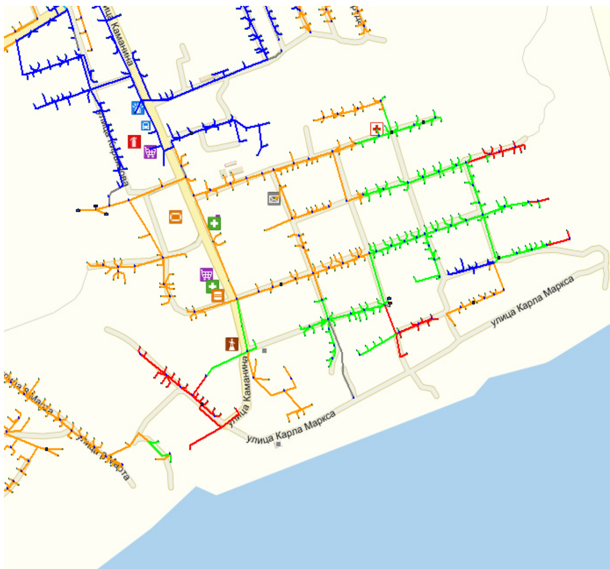
Рисунок 49 – Распределение давления в центральной зоне водопроводной сети в с. Каракулино
